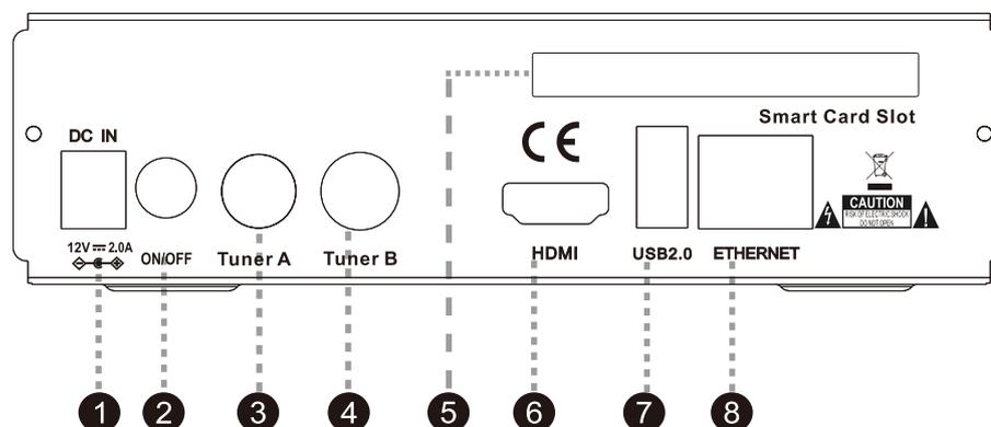
1. Prise d'alimentation CC : connectez l'adaptateur CA/CC fourni (12 V/2 A)
